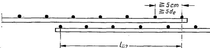
Bild 32. Übergreifungsstoß geschweißter Betonstahlmatten aus glatten oder profilierten Stäben (Beispiel für 4,5 versetzt übereinanderliegende Maschen)
