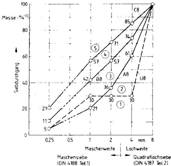
Bild 1. Sieblinien mit einem Größtkorn von 8 mm
