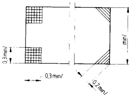
Bild 49. Rechtwinklige und schräge Eckbewehrung, Unterseite
