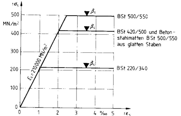
Bild 12. Rechenwerte für die Spannungsdehnungslinien der Betonstähle
