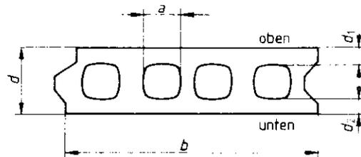
Bild 38. Stahlbetonhohldielen
