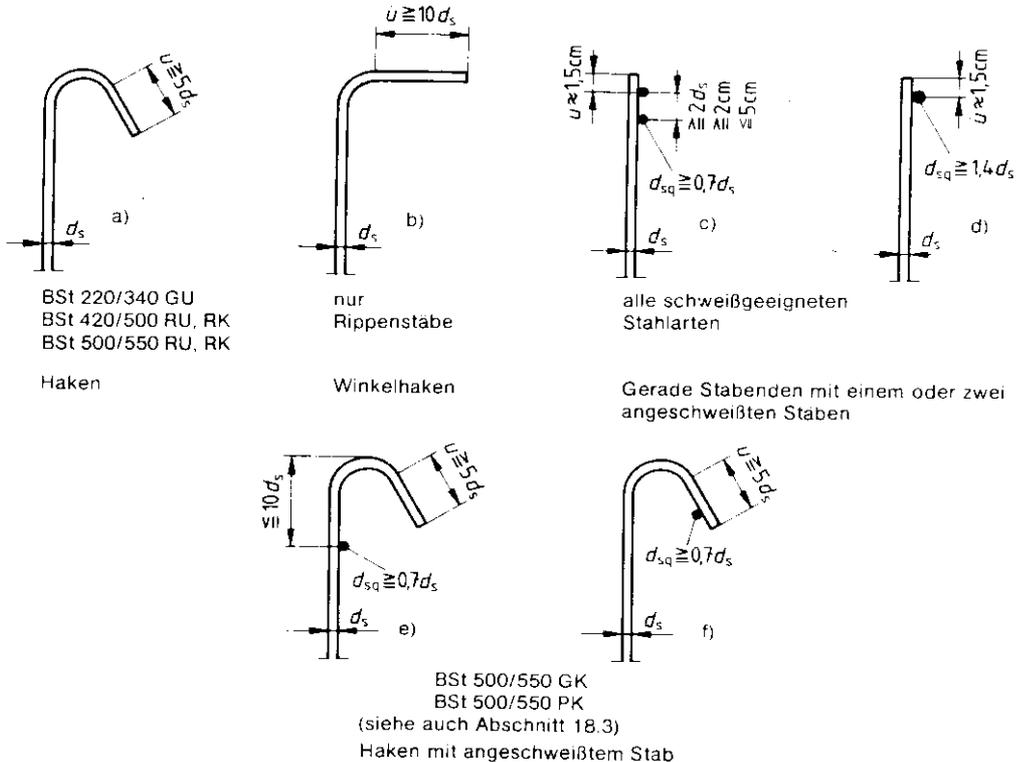
Bild 25. Verankerungselemente von Bügeln
