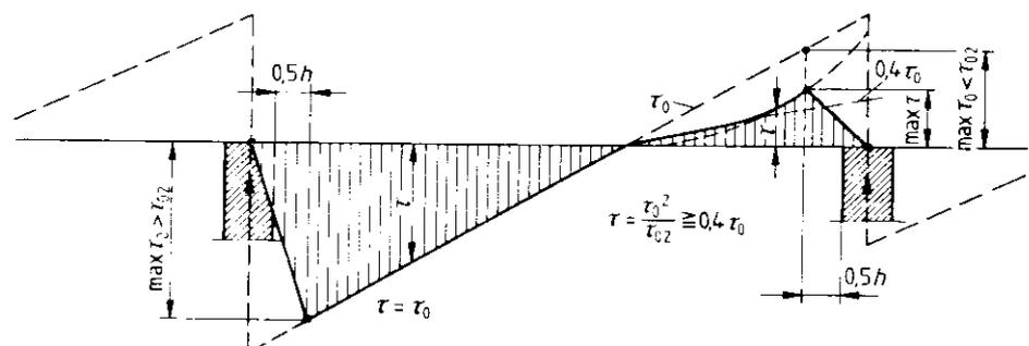
Bild 15. Grundwerte  $\tau_0$  und Bemessungswerte  $\tau$  bei unmittelbarer Unterstuetzung (siehe Abschnitte 17.5.2 und 17.5.5)
