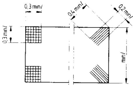
Bild 48. Rechtwinklige und schräge Eckbewehrung, Oberseite
