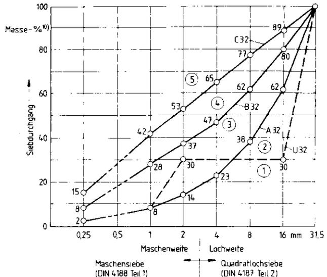
Bild 3. Sieblinien mit einem Größtkorn von 32 mm
