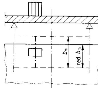
Bild 45. Reduzierte mitwirkende Lastverteilungsbreite bei Lasten in Randnähe
