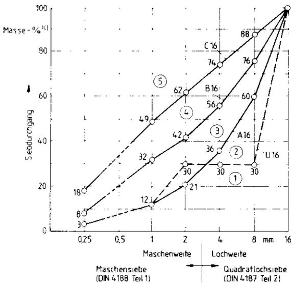
Bild 2. Sieblinien mit einem Größtkorn von 16 mm
