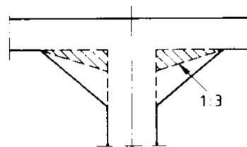
Bild 51. Berücksichtigung einer Stützenkopfverstärkung bei der Biegebemessung
