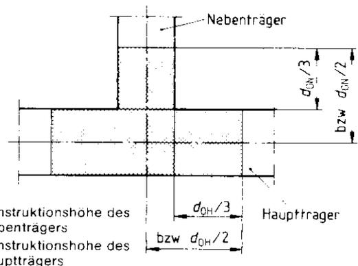
Bild 32. Größe des Kreuzungsbereiches beim Anschluß von Nebenträgern
