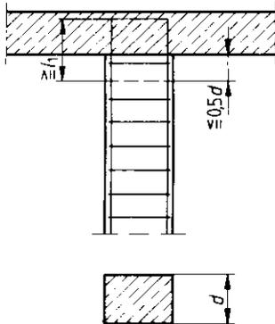
Bild 59. Verankerungsbereich der Stütze ohne besondere Verbundmaßnahmen
