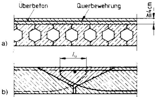
Bild 41. Beispiele für die Anordnung einer Querbewehrung
