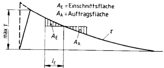
Bild 24. Zulässiges Einschneiden des Schubspannungsdiagrammes
