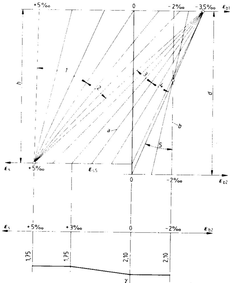
Bild 13. Dehnungsdiagramme und Sicherheitsbeiwerte (Angabe der Bereiche 1 bis 5 siehe Seite 37 oben)
