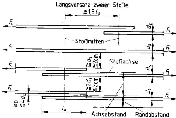
Bild 17. Längsversatz und Querabstand der Bewehrungsstäbe im Stoßbereich
