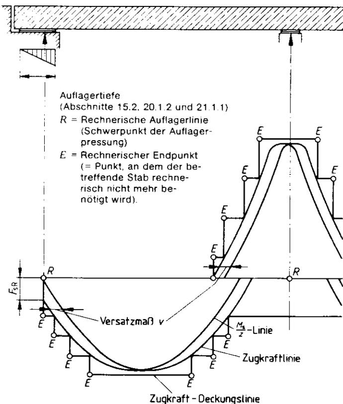
Bild 21. Beispiel für eine Zugkraftdeckungslinie bei reiner Biegung
