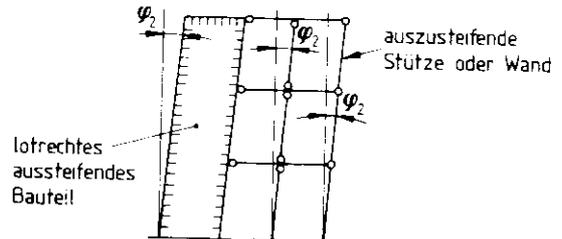
Bild 9. Schrägstellung  $\varphi_2$  aller auszusteifenden und aussteifenden lotrechten Bauteile
