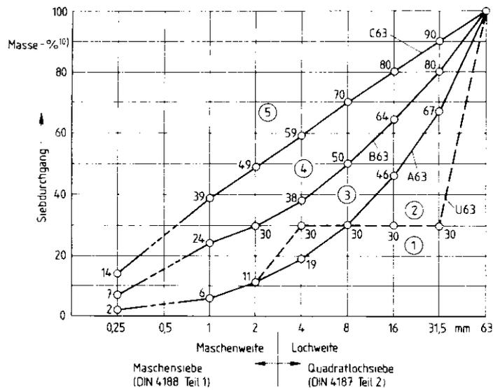
Bild 4. Sieblinien mit einem Größtkorn von 63 mm
