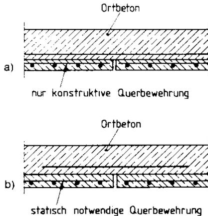
Bild 42. Beispiele für die Anordnung einer Querbewehrung
