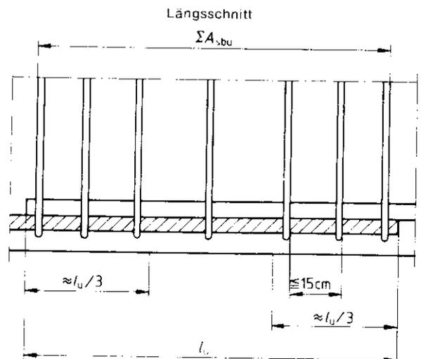
Tabelle 22. Zulässige Belastungsart und maßgebende Bestimmungen für Stöße von Tragstäben geschweißter Betonstahlmatten
