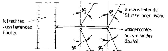
Bild 8. Schrägstellung  $\varphi_1$  aller auszusteifenden Stützen und Wände
