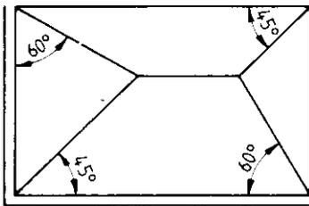
Bild 46. Lastverteilung zur Ermittlung der Stützkkräfte
