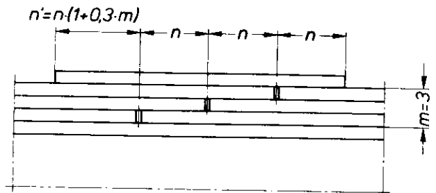
Bild 9. Erhöhung der Anzahl der Verbindungsmittel bei mittelbarer Stoßdeckung
