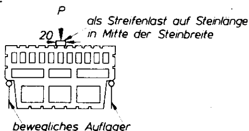
Bild 14. Prüfanordnung zur Bestimmung der Bruchlast
