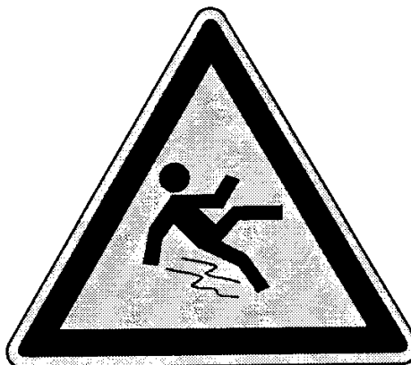
W28 Warnung vor Rutschgefahr
