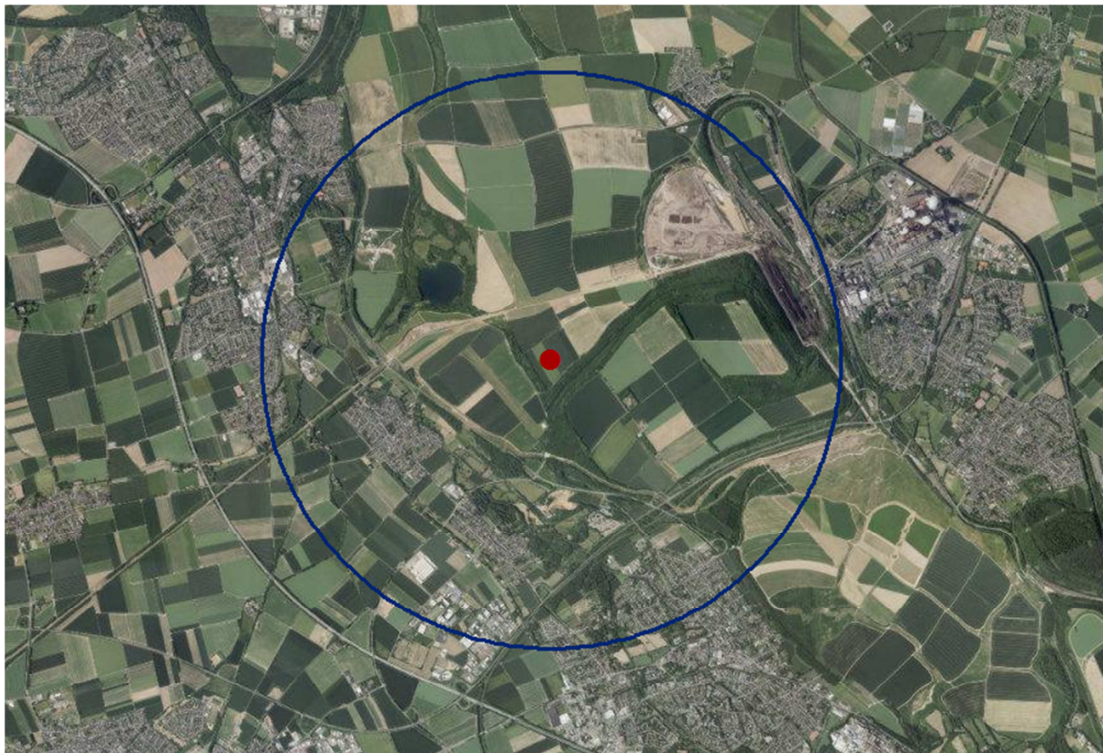
Abb. 1: Geplanter Standort einer Windkraftanlage (fiktive Planung) und Untersuchungsraum mit Radius der 15-fachen Anlagenhöhe (3 km). © Geobasisdaten, Bez.-Reg. Köln Abt. GEObasis.nrw, Bonn 2015).
